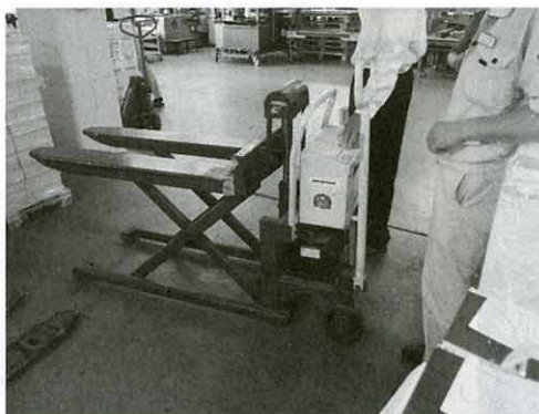
バッテリー式リフトの導入で作業効率がアップ
